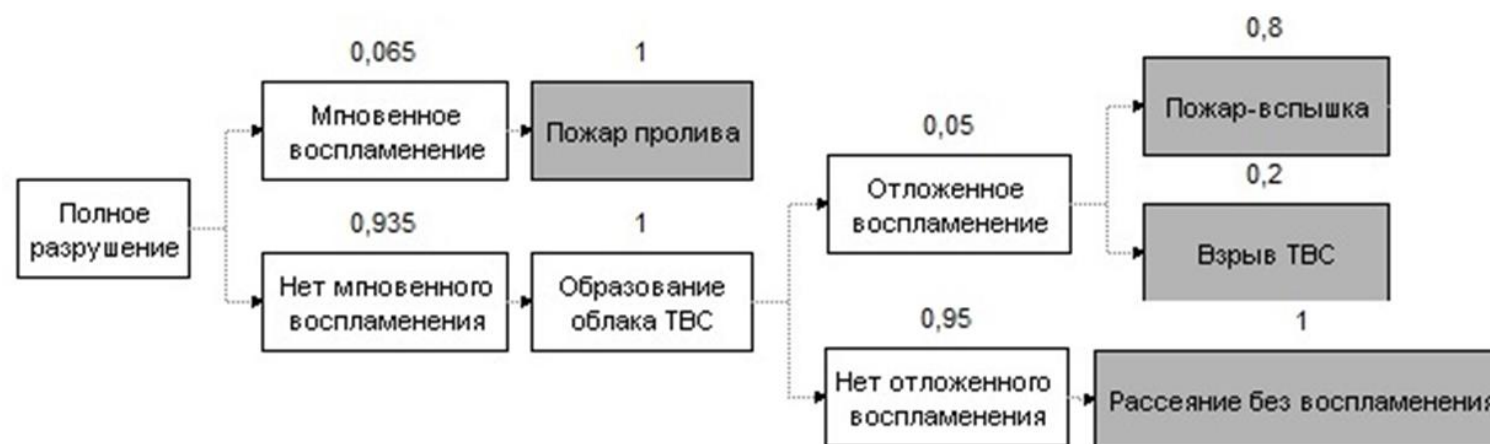
Рисунок 4 – Дерево событий при полном разрушении технологических трубопроводов (горючая жидкость и газ)
